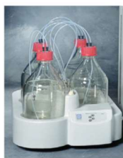
Figura 5.3. Sistemul de extracție ASE200 prevăzut cu controler pentru dozarea solvenților
