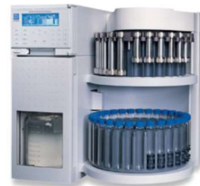
Figura 5.3. Sistemul de extracție ASE200 prevăzut cu controler pentru dozarea solvenților
